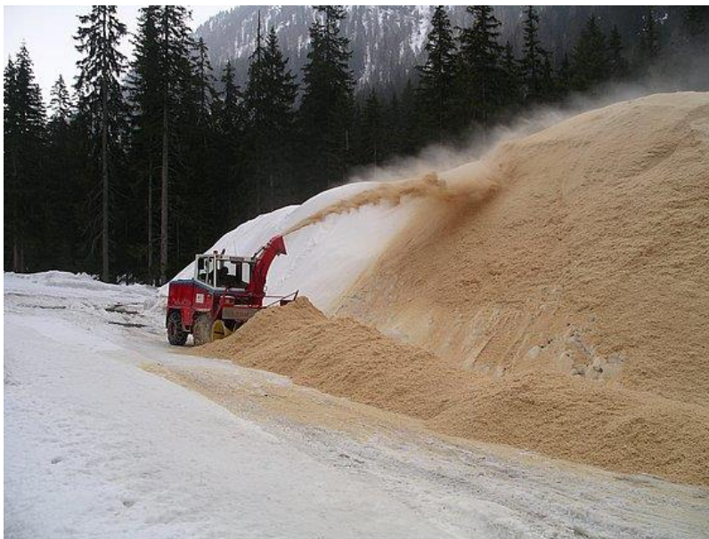
Abbildung 17: Isolationsprozess durch Holzspäne für das Snowfarming in Davos. Quelle: Wolfensperger, Fabian: in: Institut für Schnee- und Lawinenforschung, https://www.slf.ch/fileadmin/_processed_/5/b/csm_IMG5497_95f3a9fa79.jpg .
